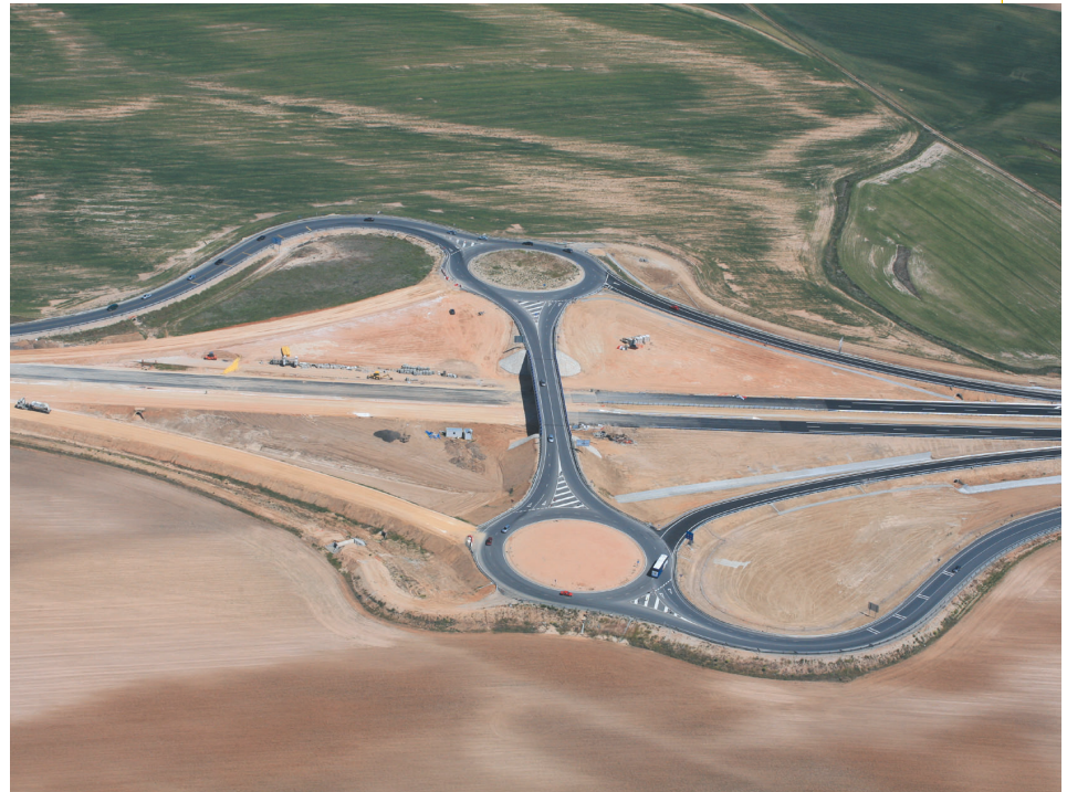
Enlace tipo diamante ubicado en el p.k. 6+200 de la obra, que conecta con la N-501 y da acceso a los municipios colindantes.
