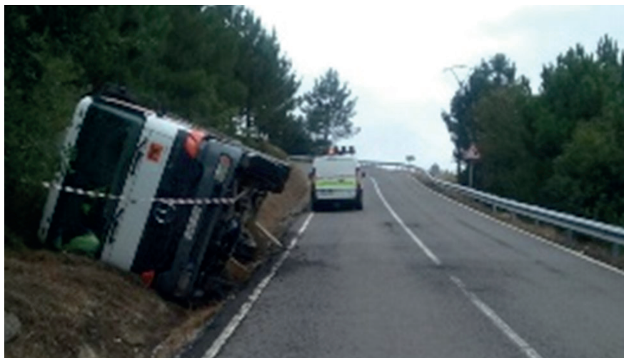
Figura 1. Vuelco en cuneta triangular profunda
