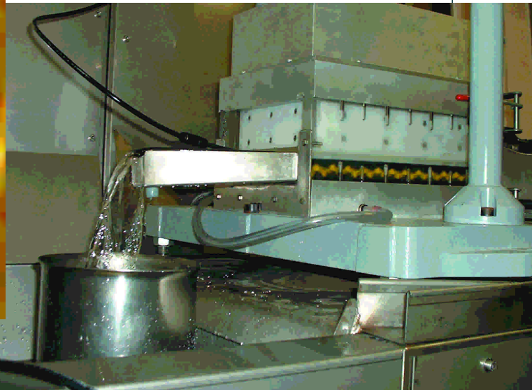
Foto izquierda: Núcleo de geocompuesto drenante con estructura alveolar simétrica. Foto derecha: Ensayo de capacidad hidráulica.
