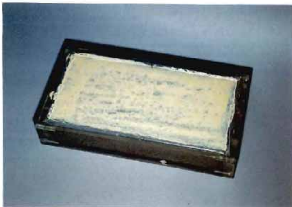
Prueba para el ensayo en cámara climática. Método ASTM-C156
