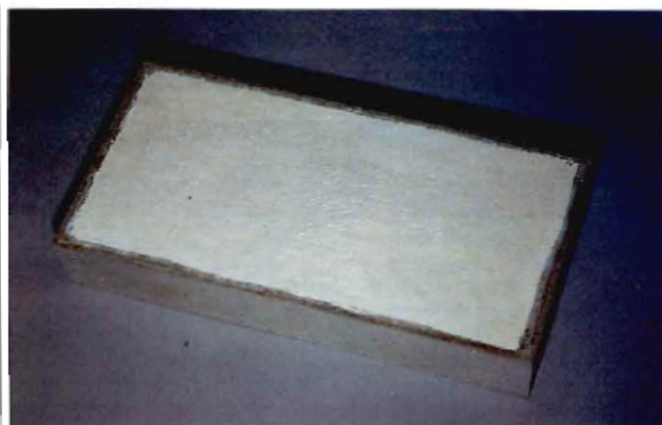
FOTO 5 Probeta con aplicación de filmógeno para ensayo en túnel de viento
