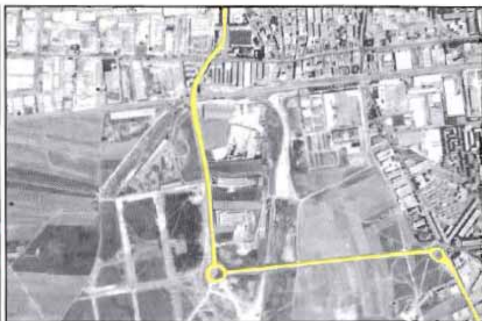
Carretera de Loeches M-206 a su paso por Torreón de Ardoz. Uso de glorietas para facilitar los cambios bruscos de trazado en planta de carretera
