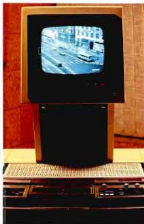
Control del tráfico por cámara de vídeo. Considerables de los detectores de tráfico zonales, que se basan en técnicas de tratamiento de imágenes en vídeo.
