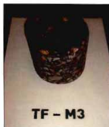
Inspección de testigos.
