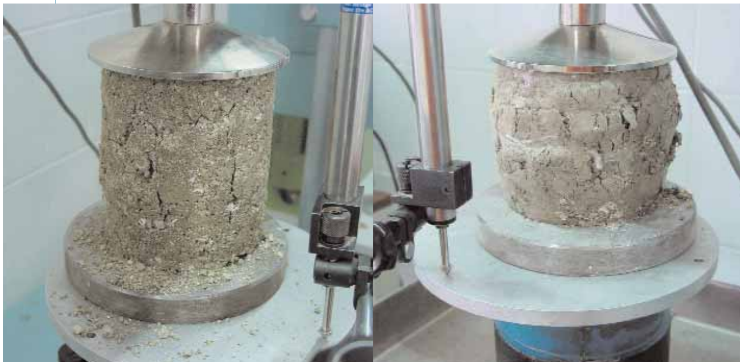
Foto 8. Rotura a compresión de suelo sin mezclar (izquierda) y con fibras largas (derecha).
