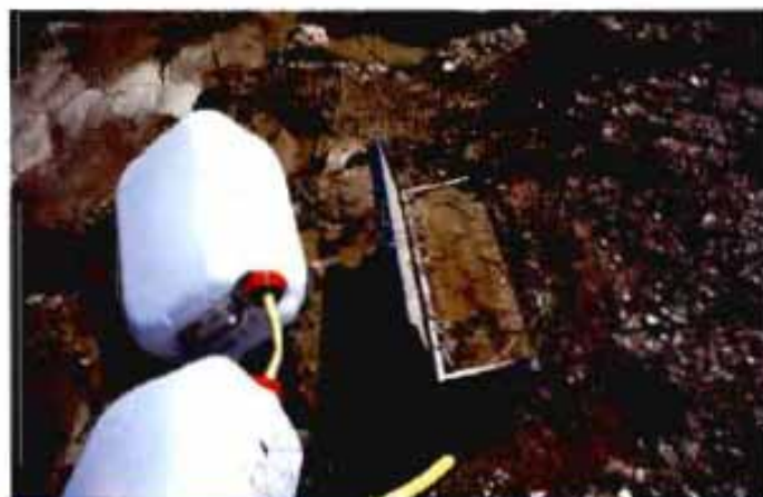
Figura 7: Colectores Gerlach con sedimentos en el mismo.
