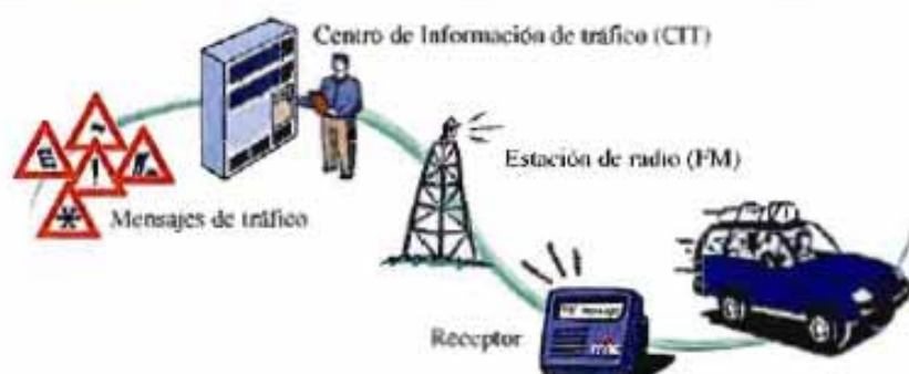
Figura 3. Cadena de mensajes ALERT C.
