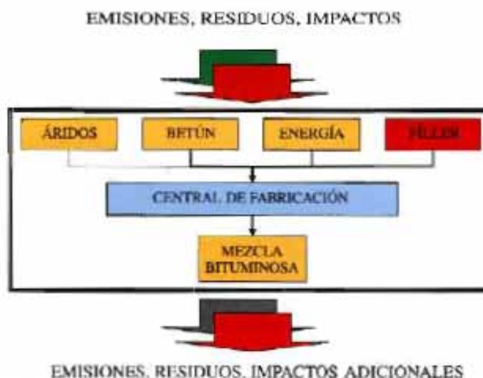
Figura 5: Diagrama de flujo que distingue los efectos medioambientales adicionales causados por la utilización de filler de aportación.
