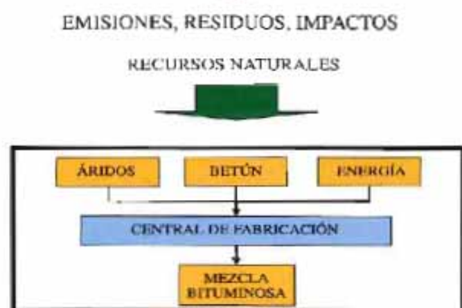
Figura 4: Un diagrama de flujo genérico y simplificado para el Análisis del Ciclo de Vida de un producto.
