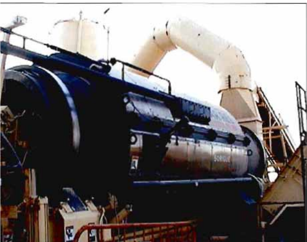
Central de doble tambor para reciclado de mezclas bituminosas en caliente.
