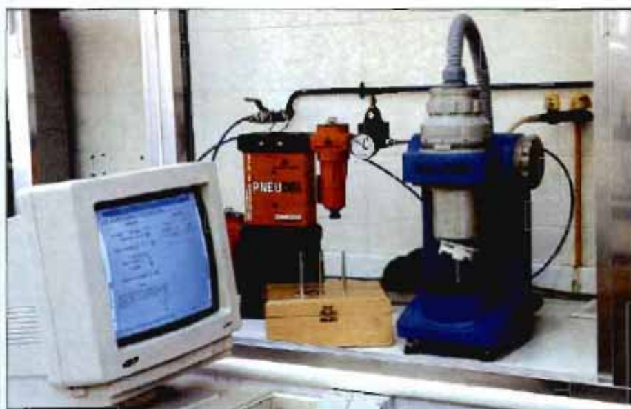
El DSR es uno de los sistemas de medida fundamentales en las especificaciones SHRP
