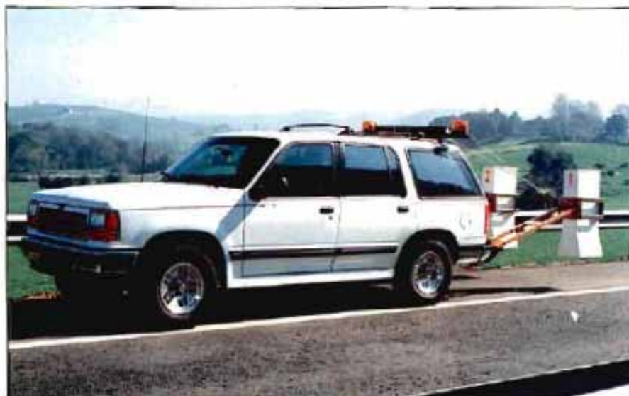
Vehículo empleado en la auscultación: Georradar.
