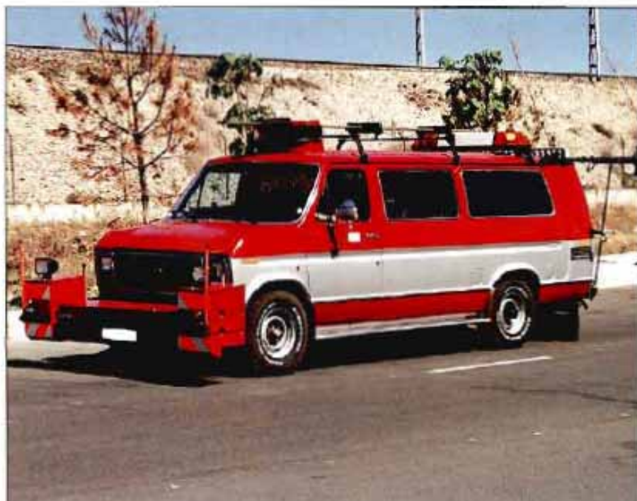
Vehículo empleado en la auscultación del IRI.
