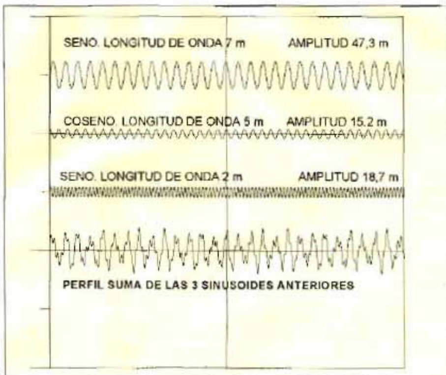
Figura 3a. Perfil longitudinal de una carretera horizontal formada por la suma de tres sinusoides horizontales, de longitudes de onda, 2, 5 y 7 m y amplitudes respectivas 18,7, 15,2 y 47,3 m.
