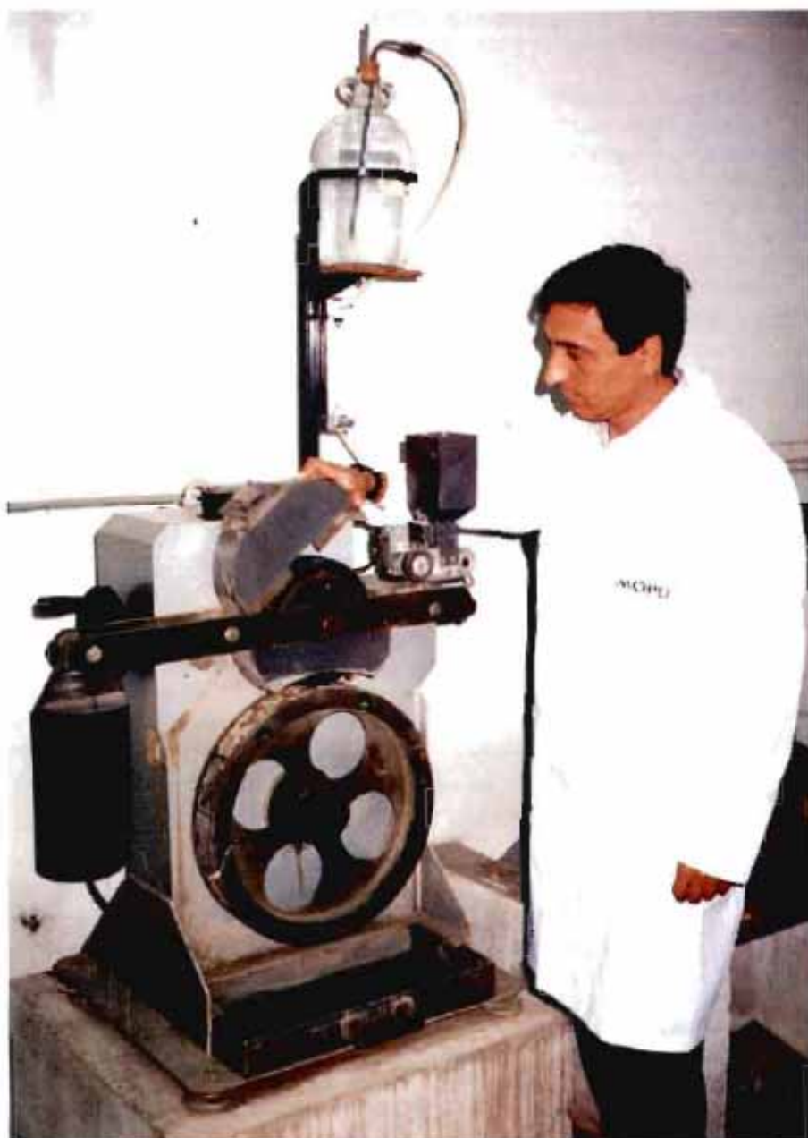
Máquina para pulido de los áridos con rueda maciza.
