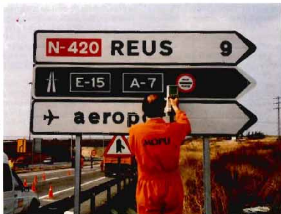
Señalización vertical: determinación de la visibilidad diurna (coordenadas cromáticas y factor de luminancia) en una inspección realizada en la provincia de Tarragona.
