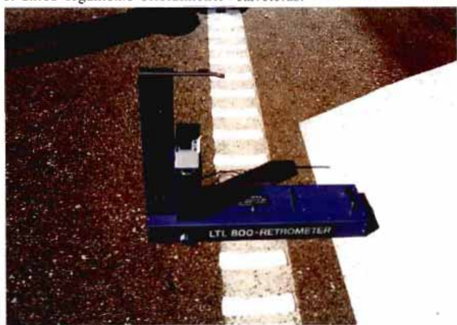
Señalización horizontal: determinación específica de la visibilidad nocturna en perfiles escalonados.
