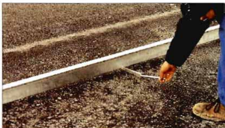
Medida de la regularidad superficial con regla de tres metros
