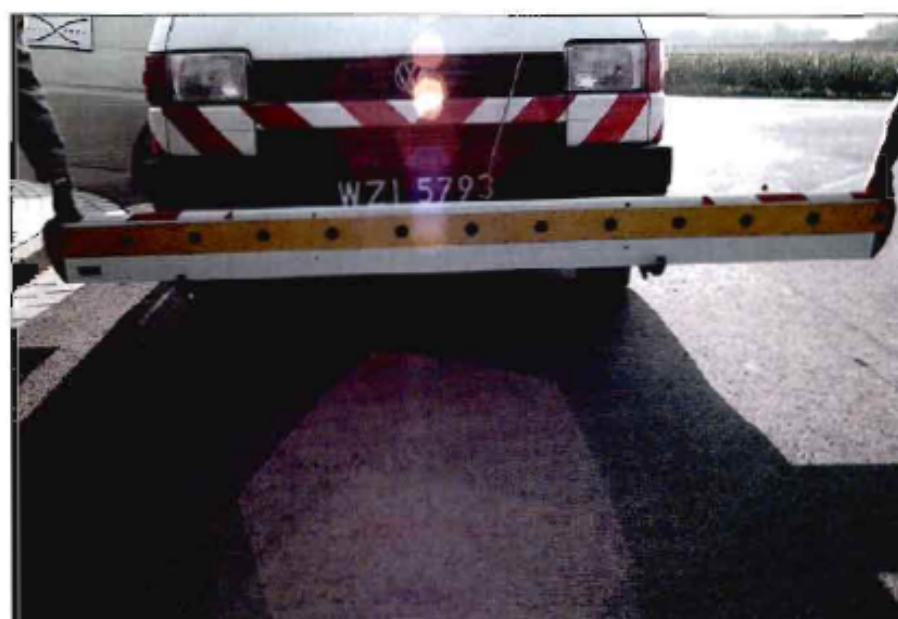
Detalles de la barra del perfilómetro láser de medida de regularidad transversal.
