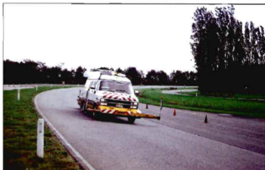
Vehículo belga con dos equipos de medida, longitudinal y transversal, durante el ensayo en la pista de la DAF.
