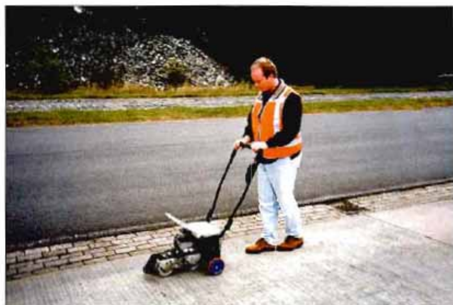
Equipo australiano de referencia Walking Profiler.
