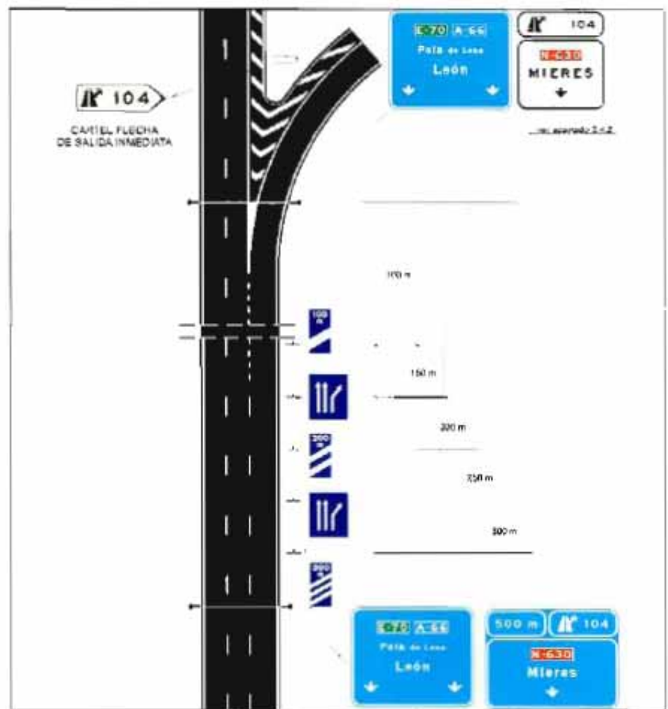
Figura 40 de la 8.1-C. Salida con pérdida de carril en el tronco.
