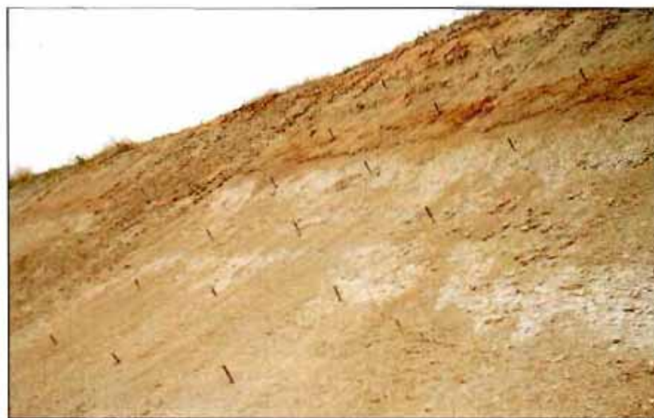
Foto 3. Parcela de clavos de erosión antes de la gran tormenta del 15/7/97.
