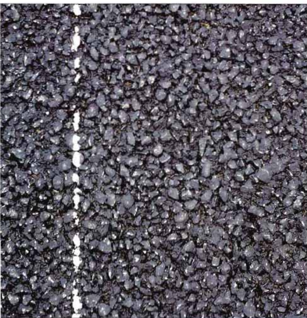
Drainante fabricada con betún modificado tipo BM-3a.
