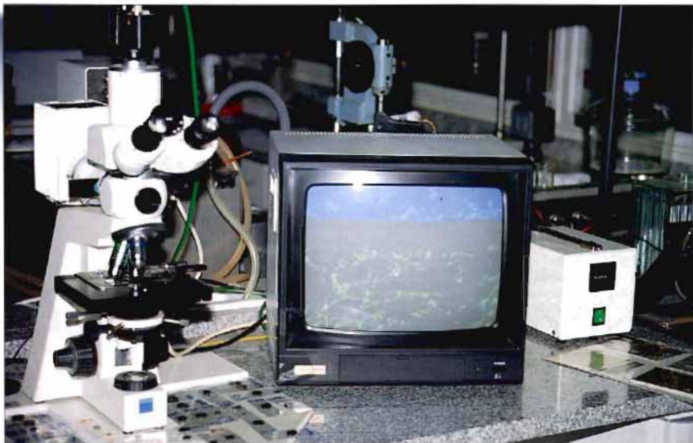
Foto 1. Equipo de microscopía de fluorescencia para el estudio en laboratorio de los hatunes modificados
