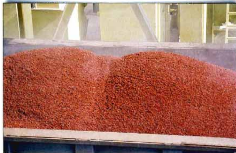
Foto 11. Mezcla de color rojo fabricada con betún sintético.
