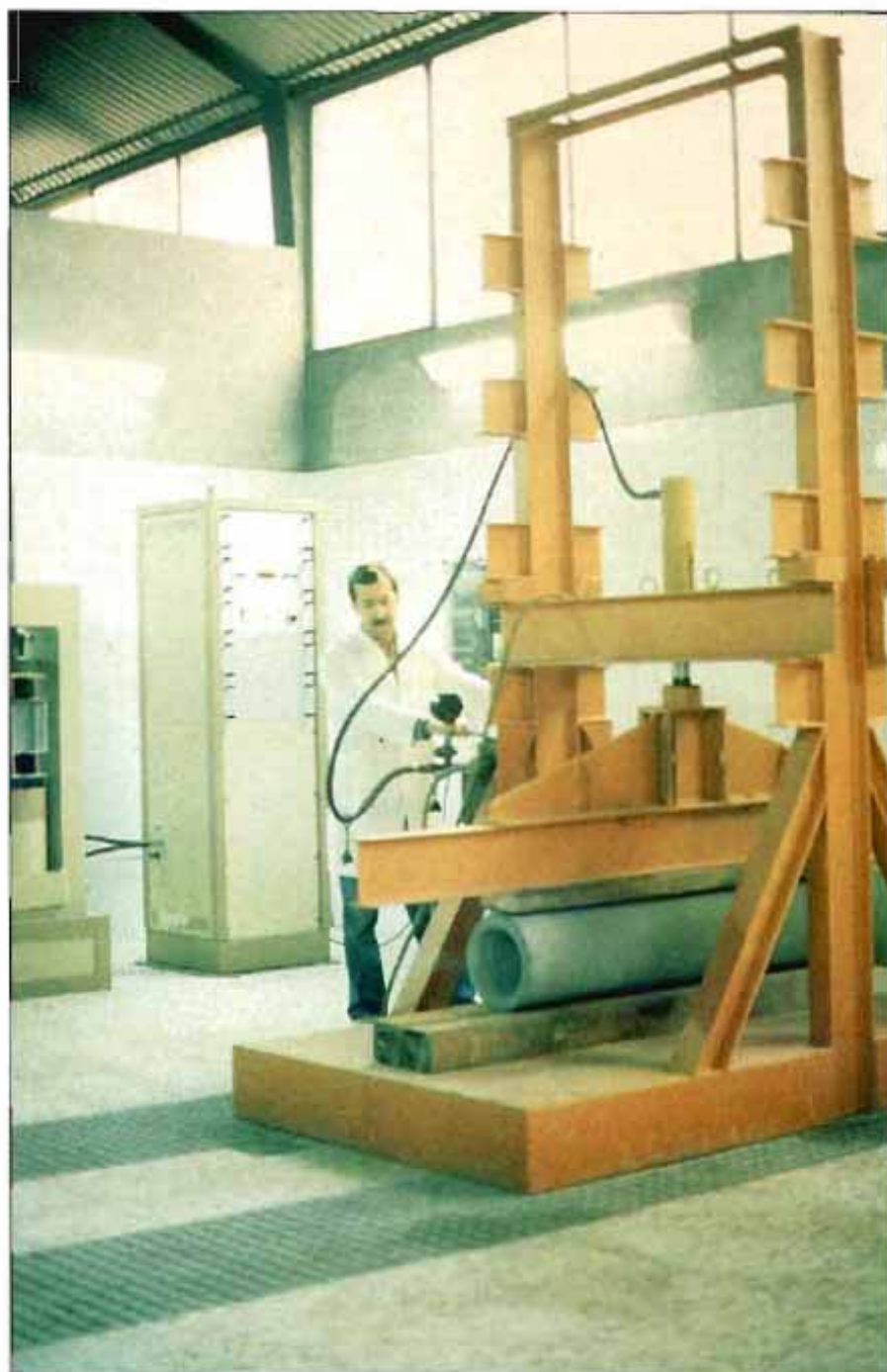
Figura 18. Ensayo de tres aristas para la obtención de la carga de rotura de una tubería.
