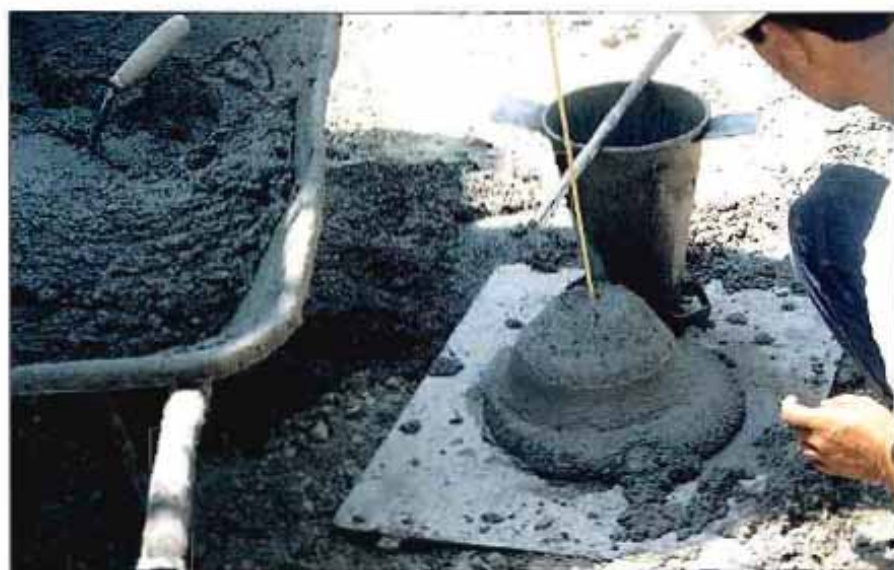
Figura 14. Medida de la consistencia de un mortero ligero con cono de Abrams
