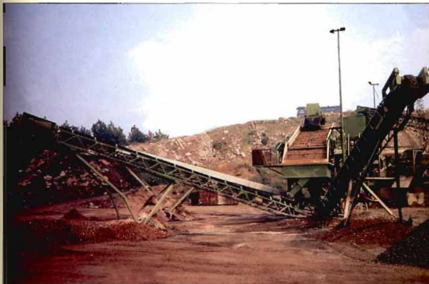
Planta de tratamiento de áridos recuperados.
