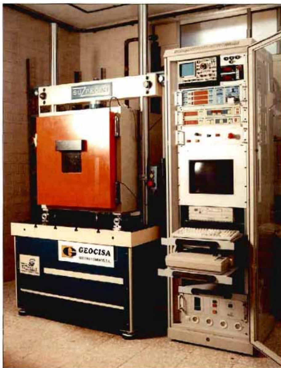
Equipo de laboratorio para la realización de ensayos comparativos de tratamientos antifisuras.
