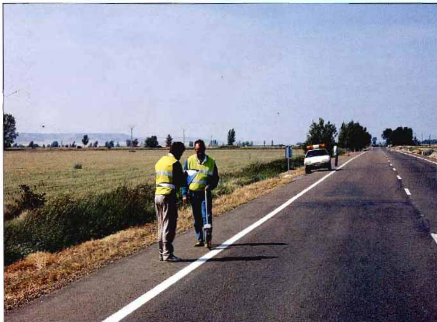
Anotación de deterioros durante la inspección visual
