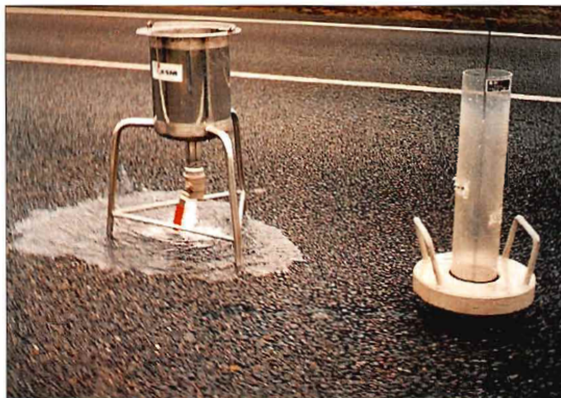
Drenómetro de Zarauz y Permeámetro NLT
