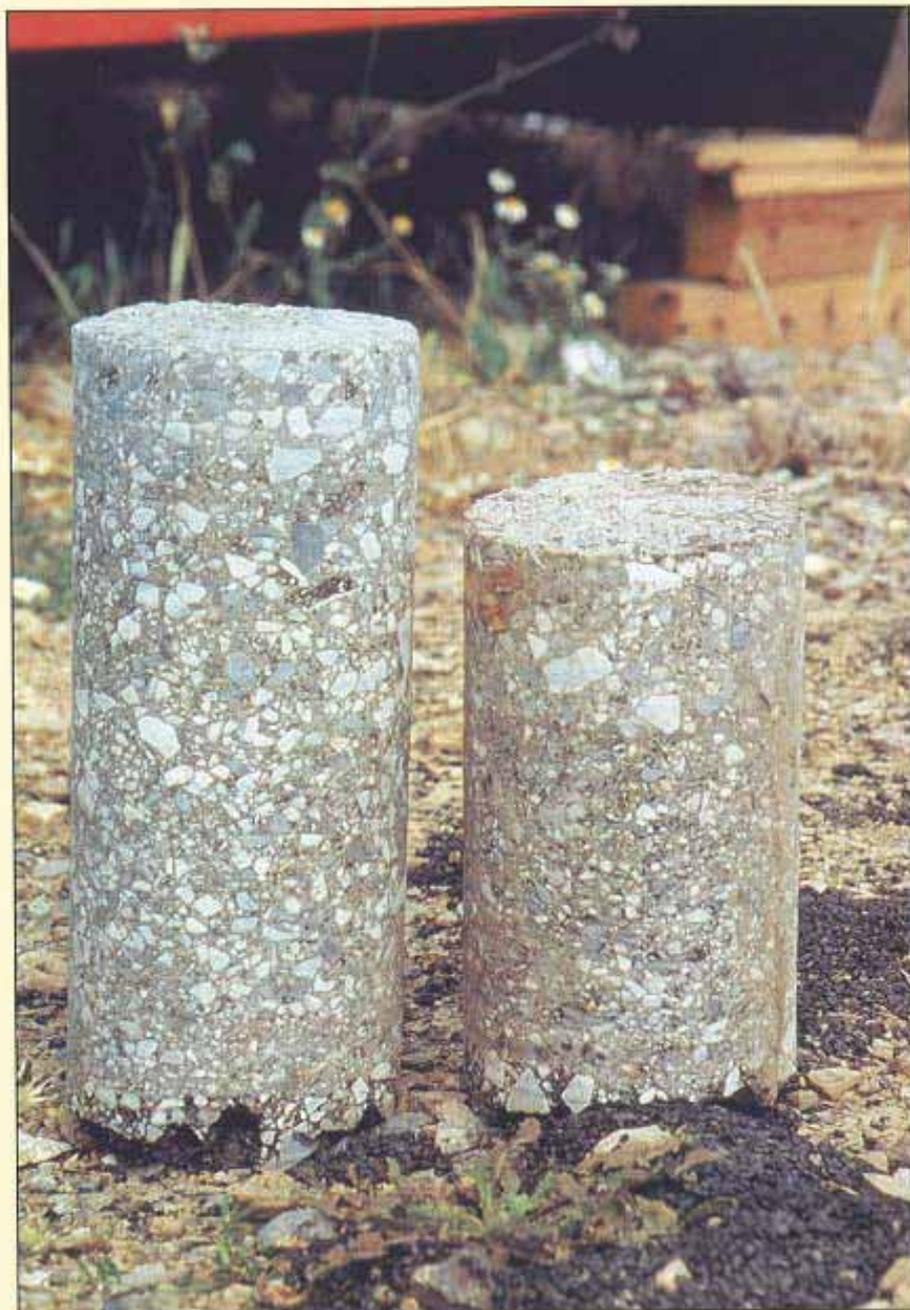
Testigos de material reciclado con cemento.
