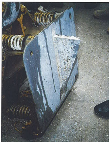
Figura 4a. Variante de Archidona (hormigón compactado): detalle de placa vibrante con cuchilla soldada para la ejecución de junta en fresco
