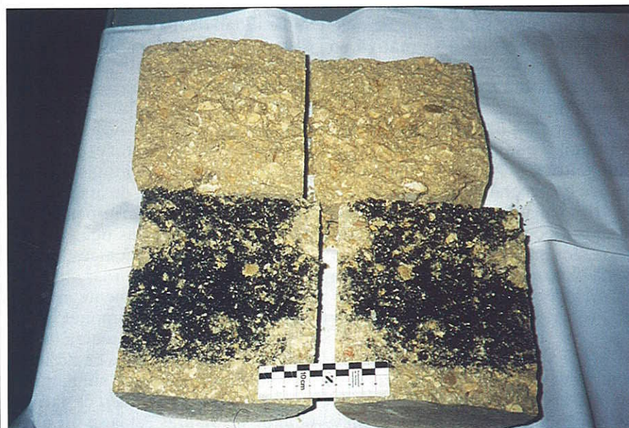
Figura 13. N - I, Salvatierra: testigos extraídos de una junta (con mancha de emulsión) y de una zona entre juntas, después de haber sido ensayados a tracción indirecta
