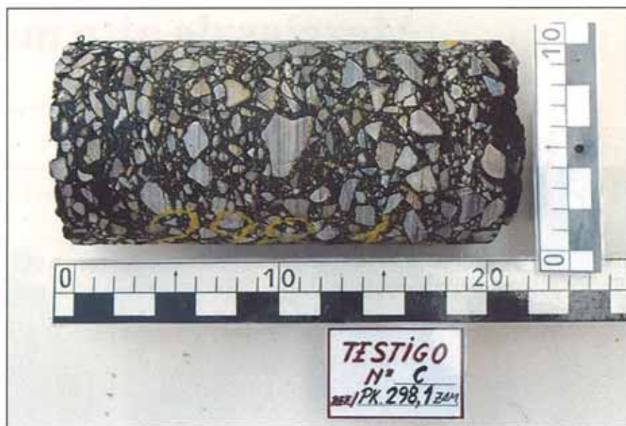
Testigo extraído del firme (mezcla drenante + mezcla alto módulo + firme antiguo).
