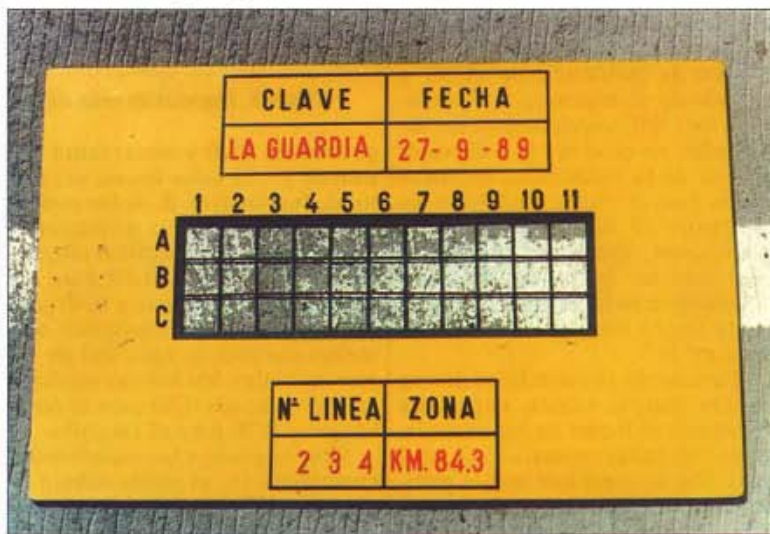
Figura 8. Plantillas para determinación del grado de deterioro de las marcas viales.
