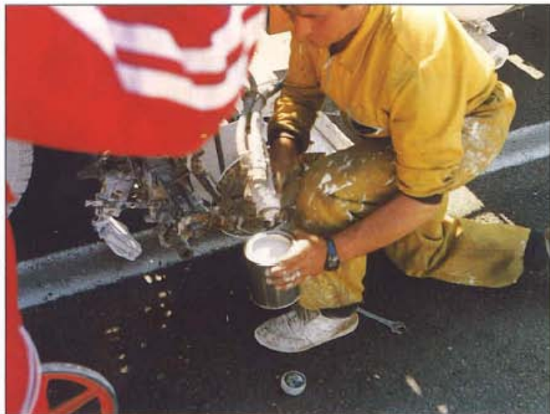
Figura 2. Toma de muestras para ensayos de identificación.
