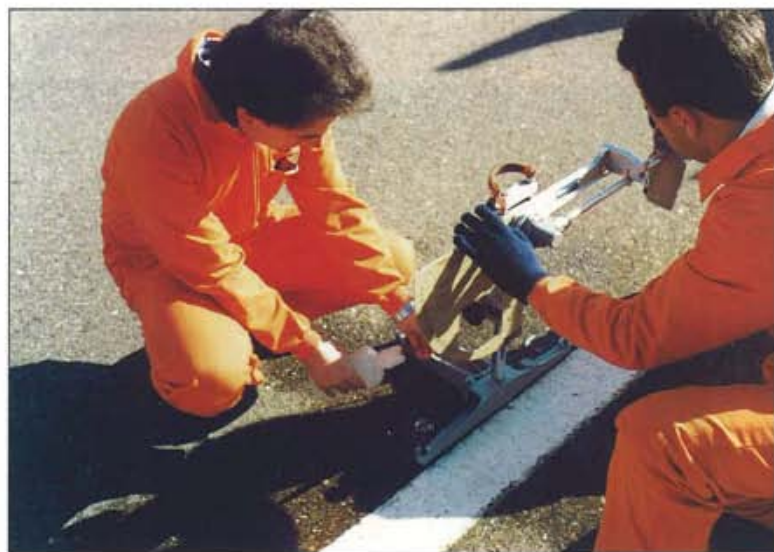
Figura 7. Medida del coeficiente de resistencia al deslizamiento de las marcas viales.
