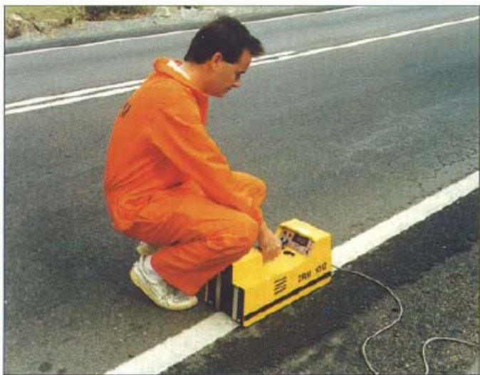
Figura 4. Medida de la visibilidad nocturna de las marcas viales.
