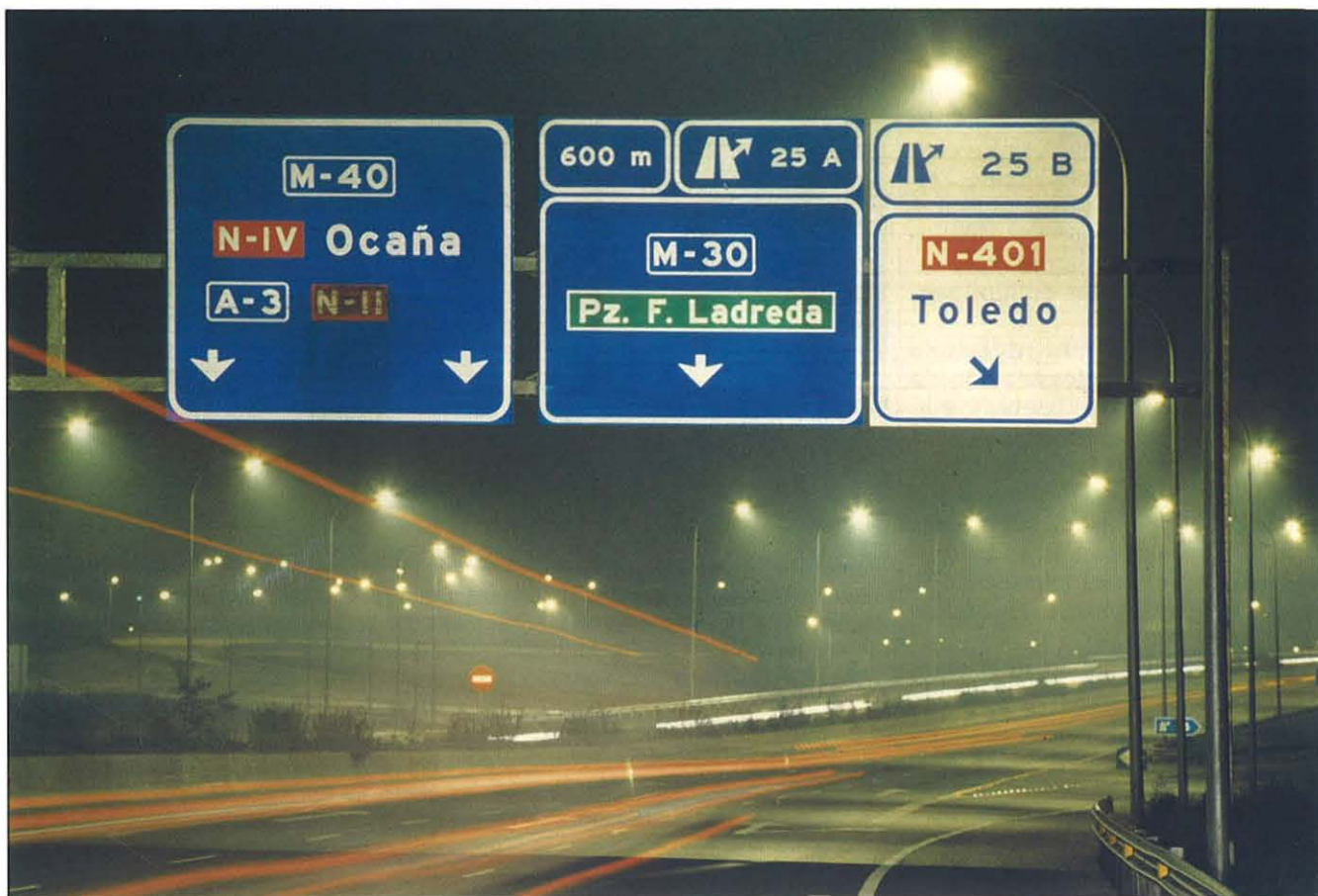
Foto 4. El rango de luminancia óptica de una señal de tráfico dependerá de su ubicación, así como de la iluminancia (E/lux) ambiente.
