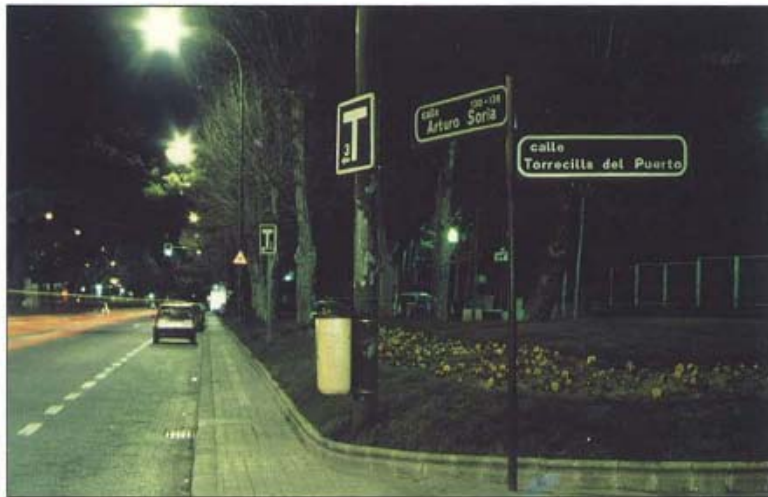
Foto 5. En entornos urbanos (iluminancia elevada), o para ángulos de iluminación superiores a 15^\circ , la percepción de los mensajes contenidos en las señales sólo podrá garantizarse mediante la utilización de materiales retrorreflectantes de alto valor de luminancia ( L/cd+m-2 ).
