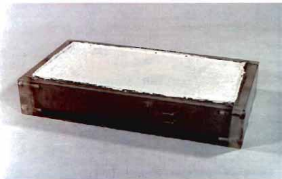
Foto 2. Vista de la probeta de hormigón ensayador. Molda de metacrilato y superficie con producto de curado.
