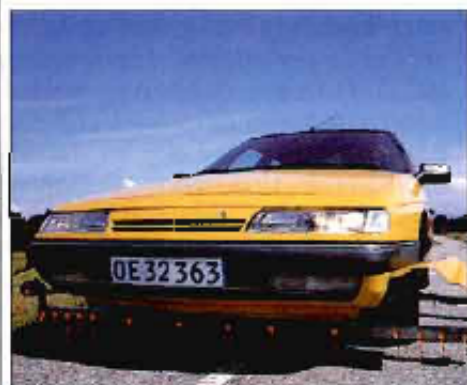
Equipo de alto rendimiento de control de regularidad superficial mediante rayos laser.
