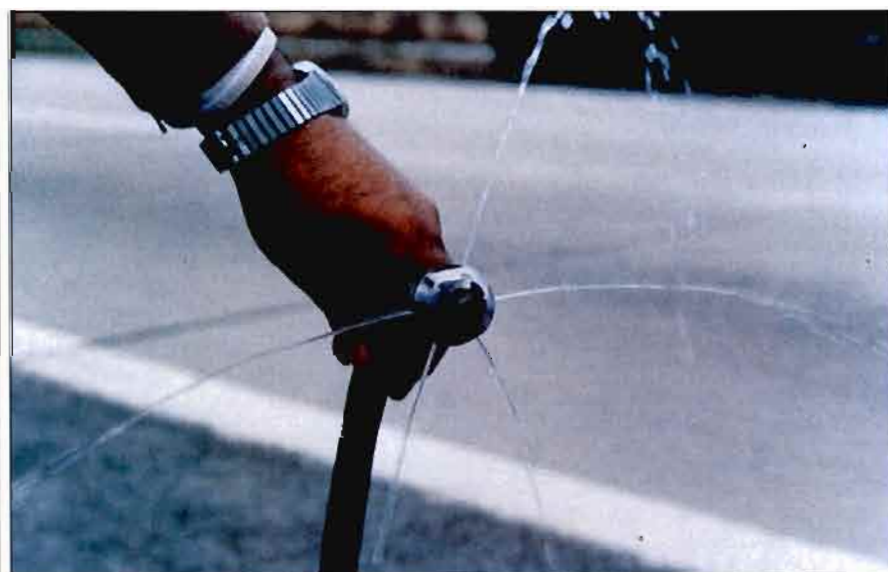
Foto 7. Detalle del equipo para la limpieza de los tubos ranurados.
