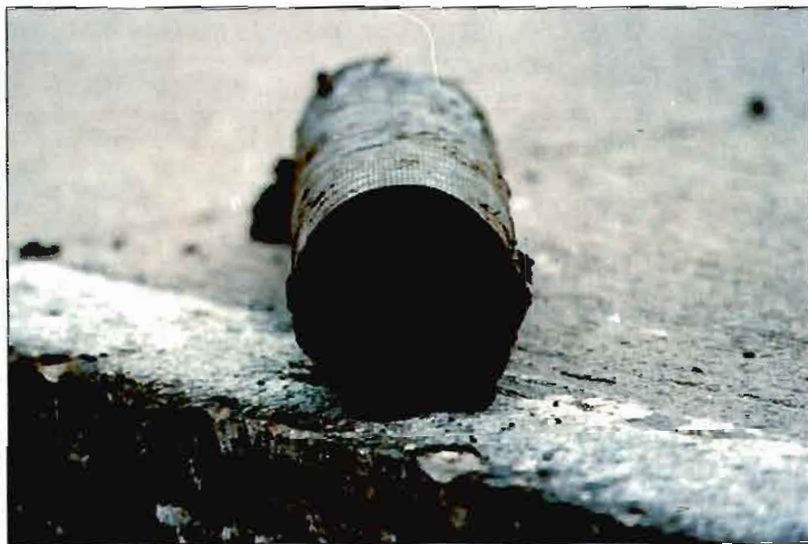
Foto 6. Detalle del tubo colector, con toda la sección rellena de los finos procedentes de la explanada.
