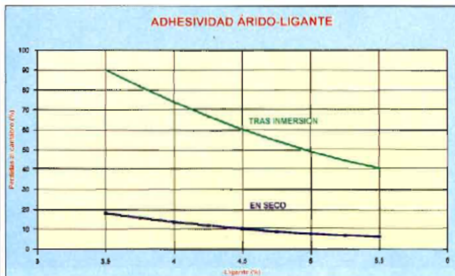
Figura 2. Evaluación de la adhesividad árido-ligante. Pérdidas al cántabro en seco y tras inmersión.
