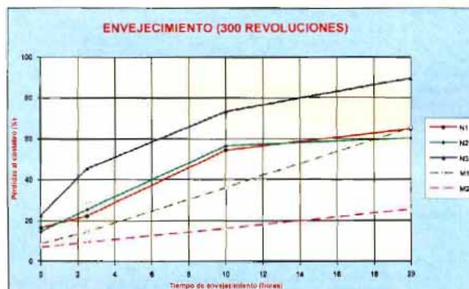
Figura 6. Efecto del grado de envejecimiento sobre las pérdidas por desgaste a 300 revoluciones.
