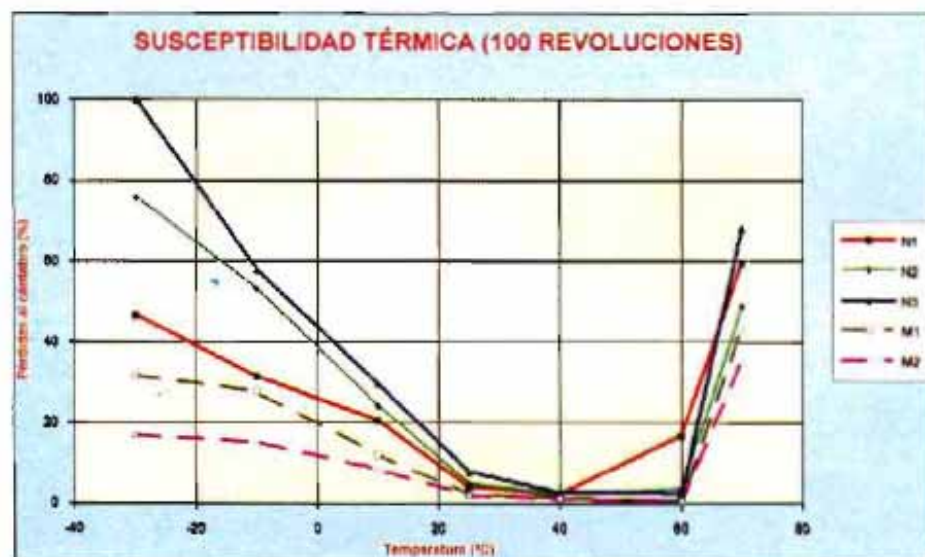
Figura 4. Efecto de la temperatura sobre las pérdidas por desgaste a 100 revoluciones.
