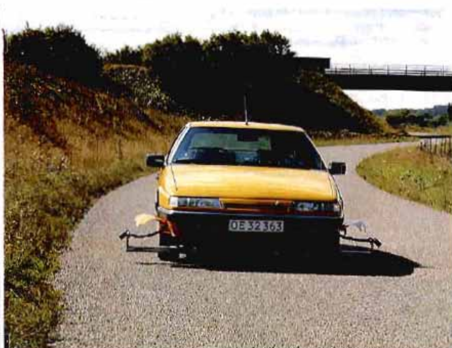
Profilograph, adquirido por el Danish Road Institute en Septiembre 1991. Dinamarca.
