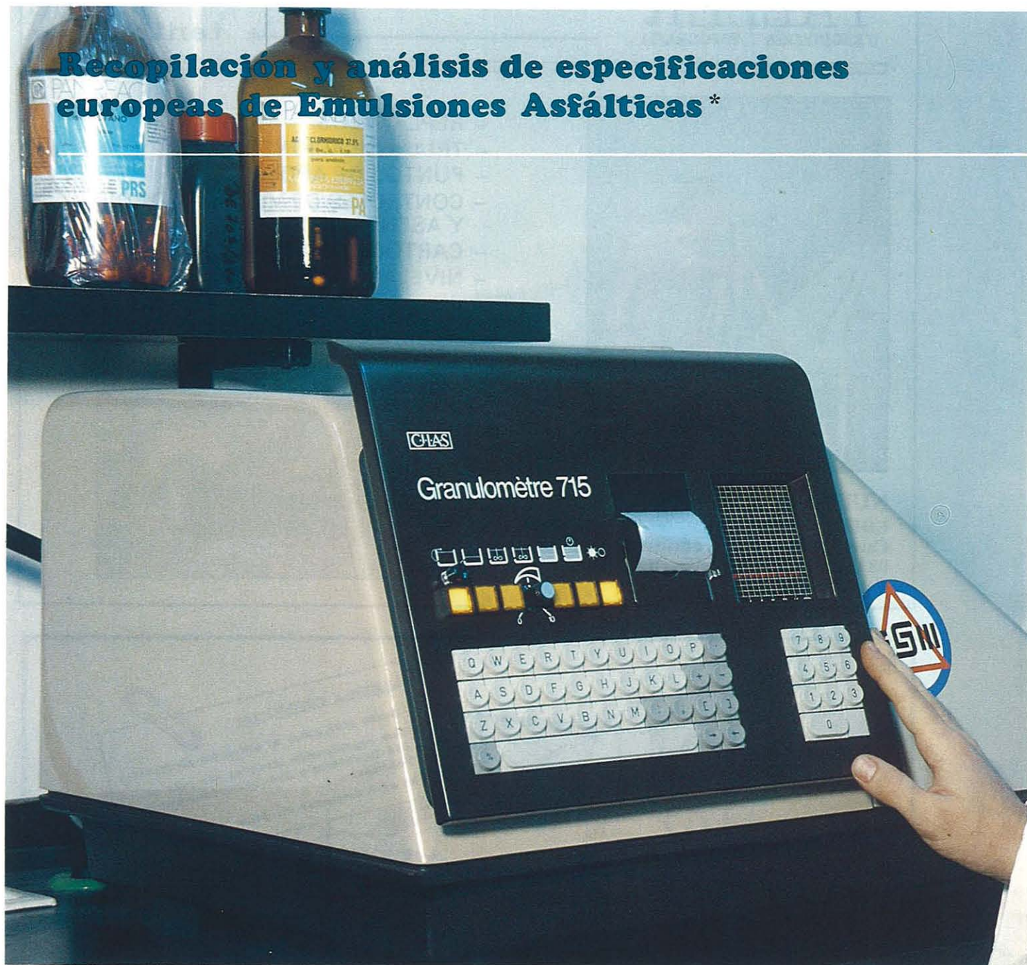
Determinación por láser del tamaño de partícula del glóbulo de betún en emulsiones
