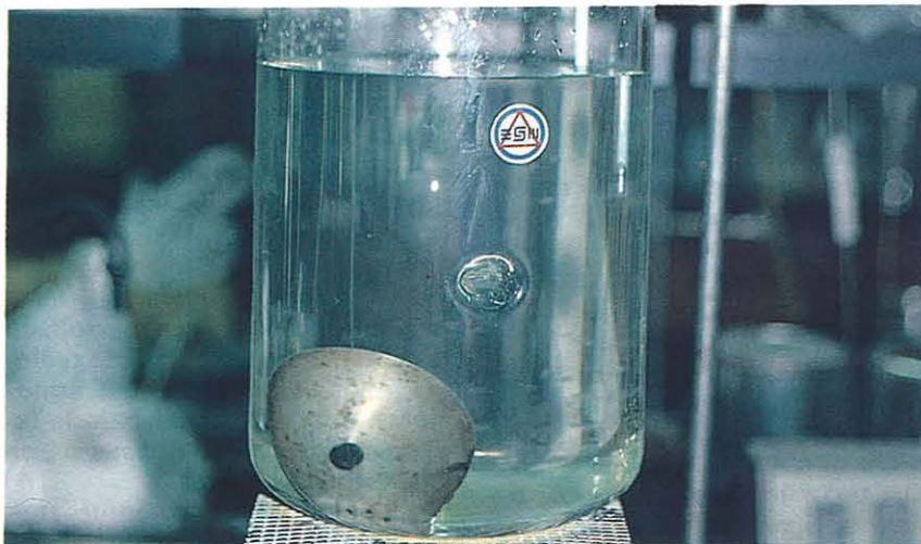
Ensayo de flotación para caracterizar la consistencia de ligantes
