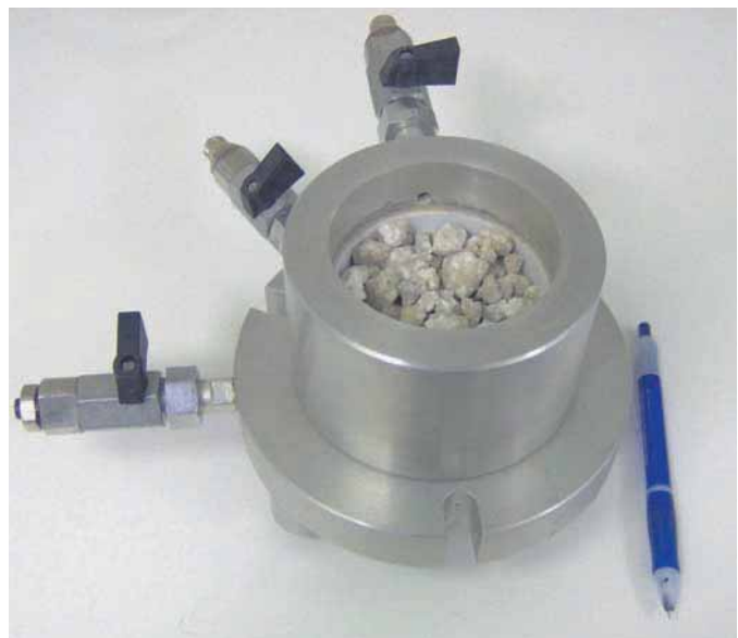
Aspecto de los materiales con granulometría tipo terraplén en su ensayo. Foto: Hernán Patiño.
