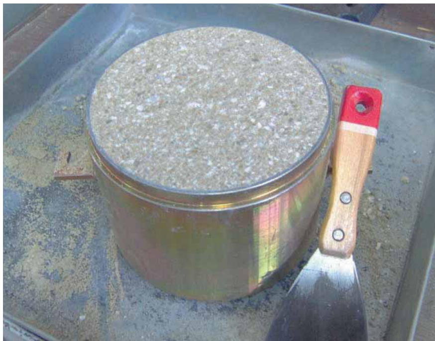
Probeta fabricada con materiales yesíferos. Fotografía: Hernán Patiño.
