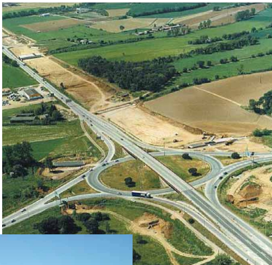
Enlace de acceso al aeropuerto de tipo glorieta a nivel del terreno y ramales directos.
