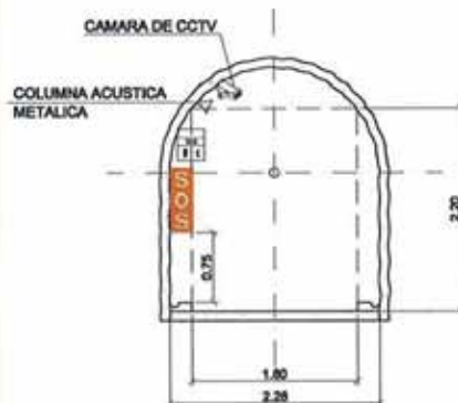
Galerías de evacuación. Sección tipo de proyecto.
