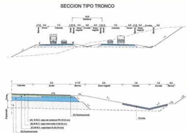
Figura 4. Sección tipo del tronco y de la sección del firme.
