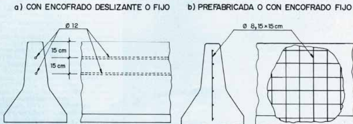
Figura 4: Armado de la barrera rígida de seguridad.
