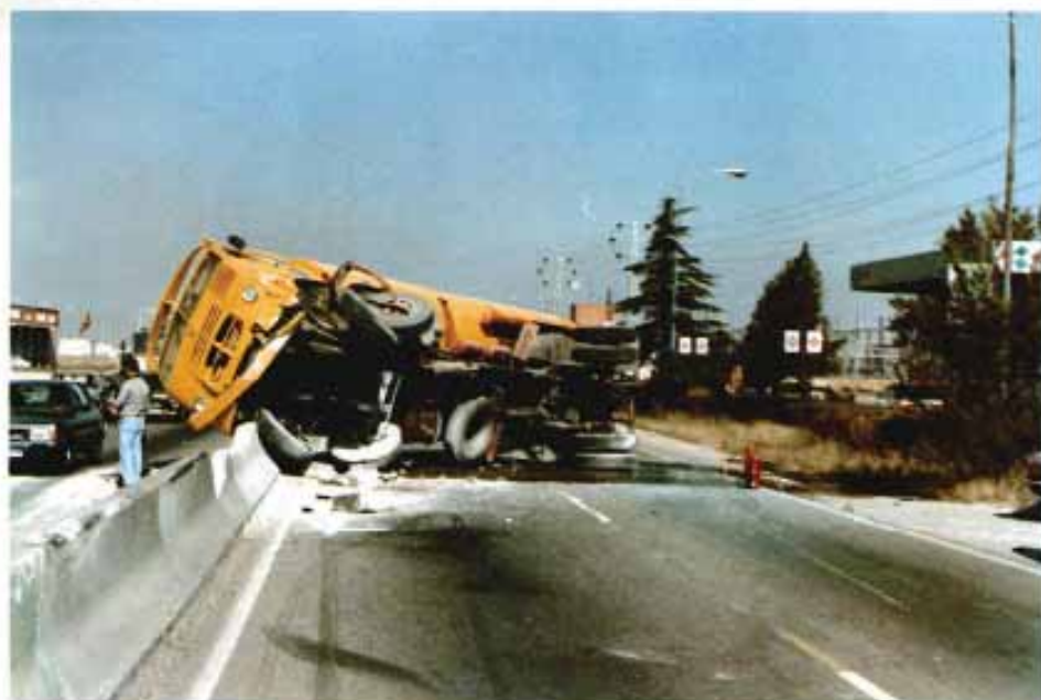
Eficacia de la barrera de seguridad del hormigón. Carretera Nacional IV. Villaverde-Seseña.
