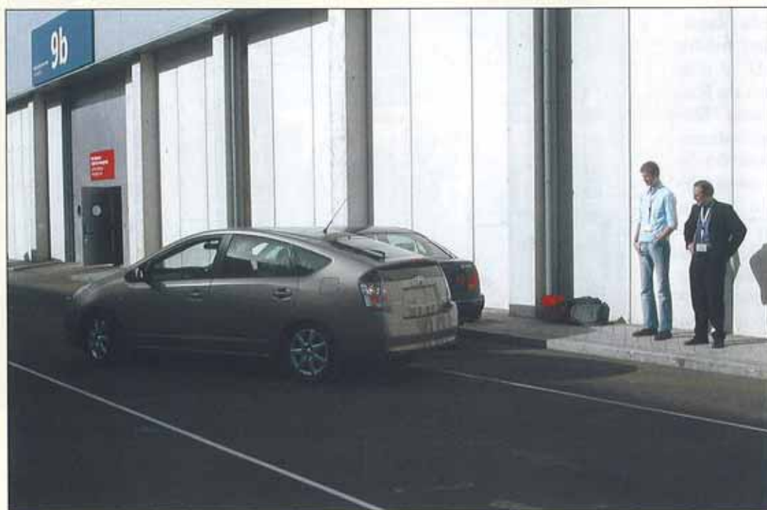
El sistema de Toyota aparcando el vehículo sin intervención del conductor.
