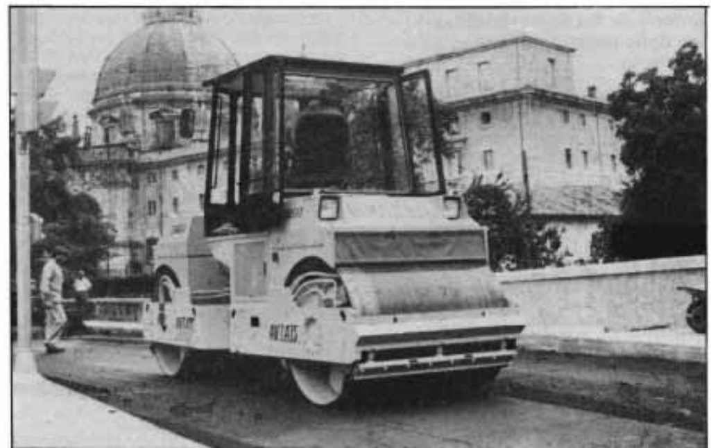
Rodillo con vibración independiente en ambos cilindros, autopropulsado y de 7,5 toneladas de peso total.
