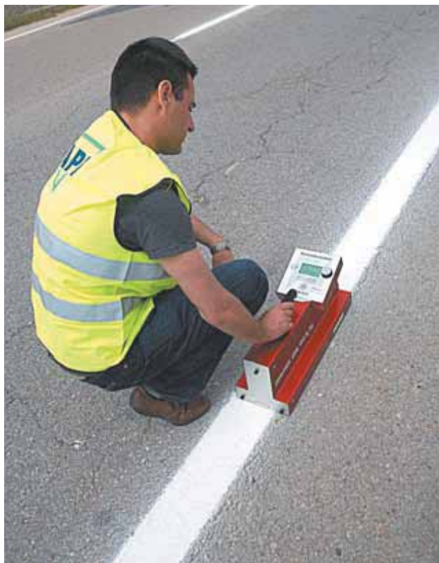
Medida de la retroreflexión de las marcas viales.
