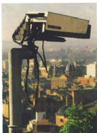
Cámara para observación remota de tráfico, de alta prestación y resolución.
