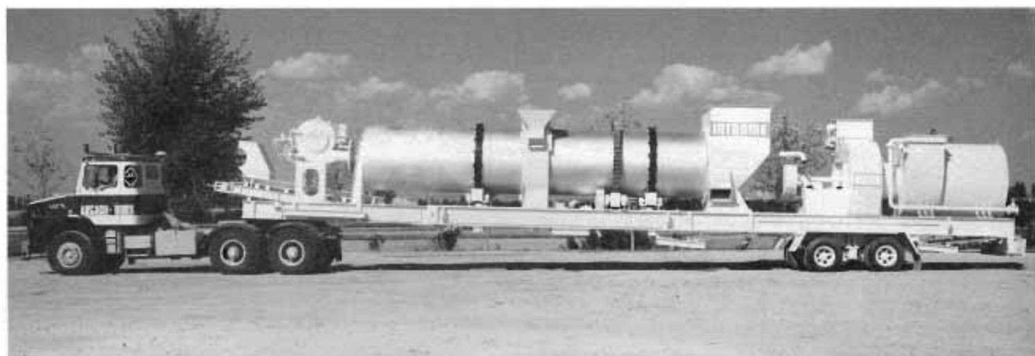
Transporte del cilindro y equipo depurador.
