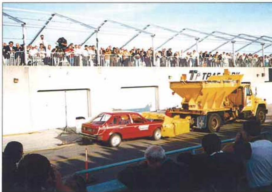
La foto recoge el impacto de un vehículo sobre un atenuador de impacto montado sobre un camión TMA
